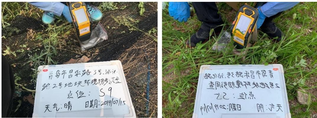
图4-3 现场 XRF 快速检测
