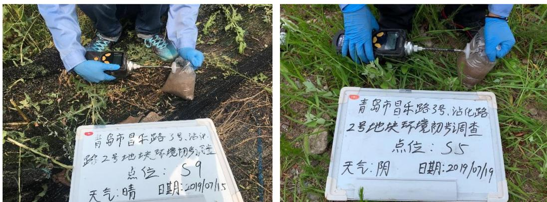
图4-4 PID 快速检测
